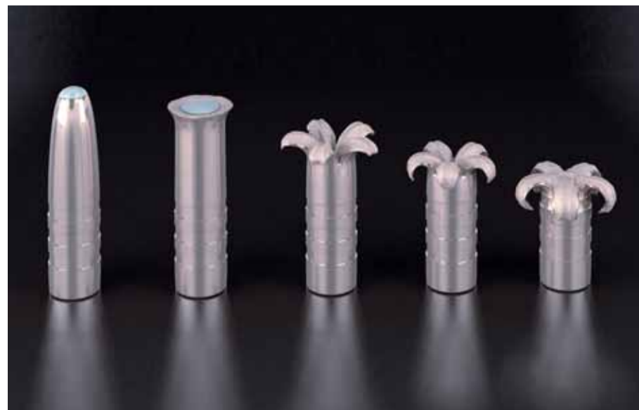
Postupná řízená deformace střely eXergy. Radiusový tvar přední části dutiny s podélnými drážkami pro rychlou deformaci usnadňuje rozevírání střely do charakteristického paprskovitěho tvaru.
